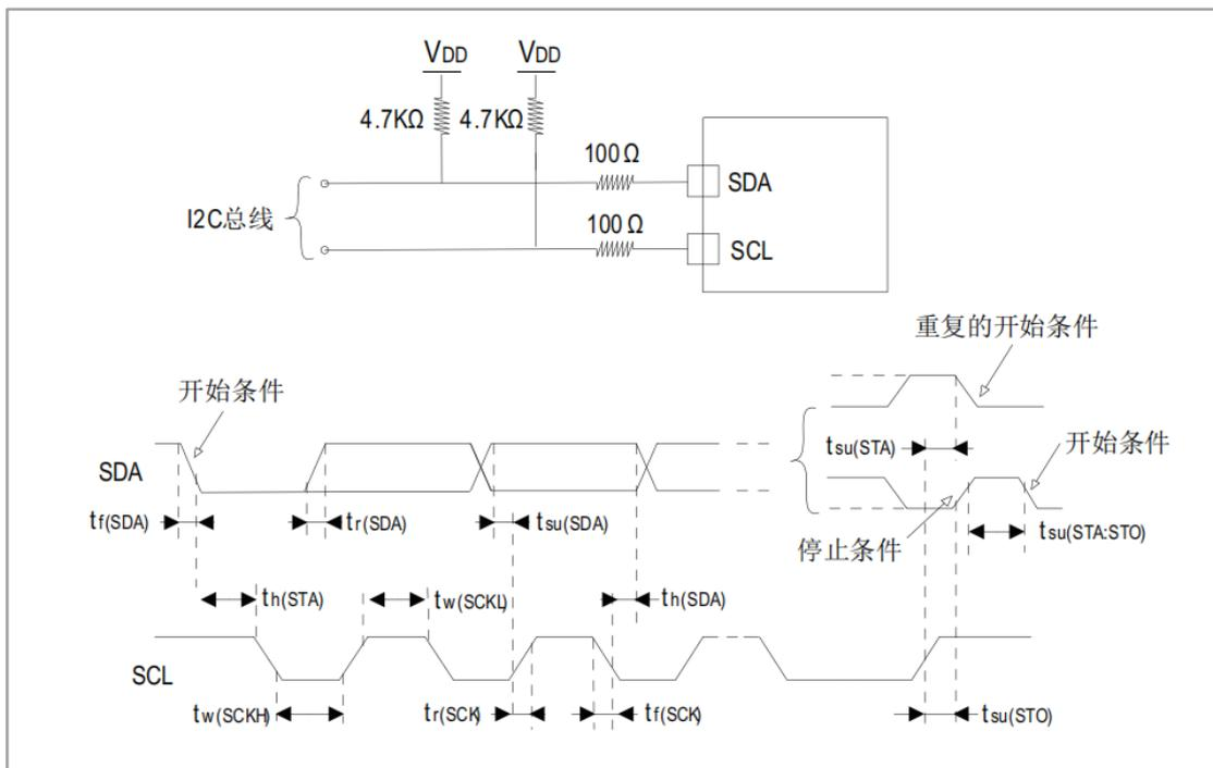
图 14. I2C 总线交流波形和测量电路
