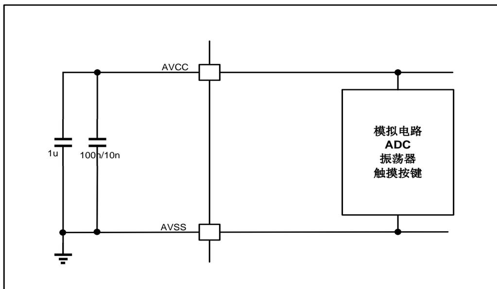
图 17. 供电电源和参考电源去藕线路
