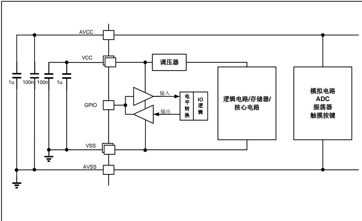
图 7. 供电方案图 (48Pin 封装条件)
