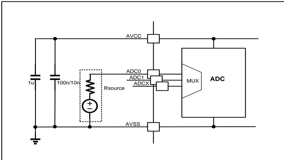
图 16 . 使用 ADC 典型的连接图
