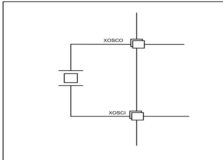
图 10. 使用 26MHz 晶体的引脚示意图
