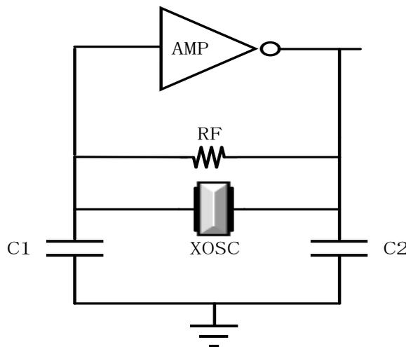
图 9. 使用 26MHz 晶体的典型应用
