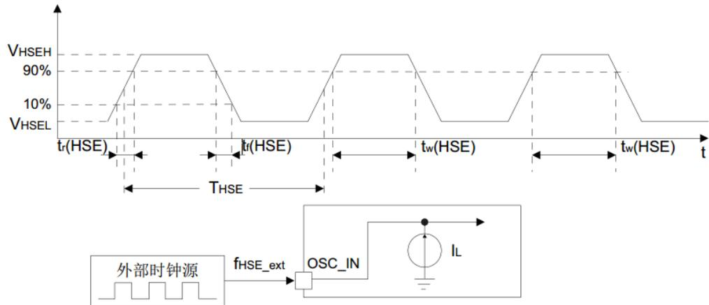
图 8. 外部高速时钟源的交流时序图
